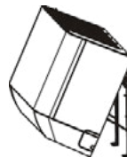
Klappen Sie die Halterung auf der Montageplatte aus.
