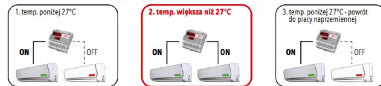
Jeżeli temperatura otoczenia wzrośnie powyżej 27°C, TS4 230V włącza kolejny klimatyzator.
